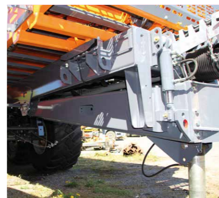
Flèche en V avec suspension hydropneumatique
