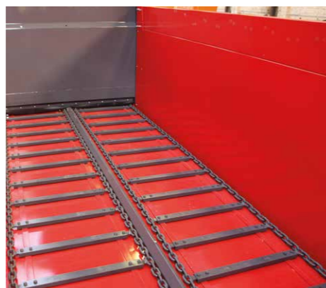
Fond mouvant 4 chaînes marines 16x56 mm avec bandes anti-usure en Hardox®
