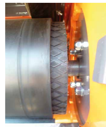
Rouleau arrière d'entraînement de forte section et vulcanisé
